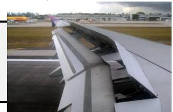
Un **aéroofrein** est un dispositif générateur de turbulences aérodynamiques servant à augmenter la traînée. Il est doté de surfaces mobiles modifiant l'écoulement de fluide autour du mobile.
