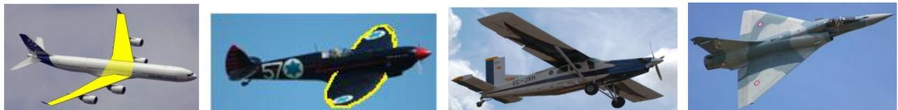
Trapézoïdale en flèche    Elliptique (Spitfire)    Rectangulaire (Pilatus)    Delta (Mirage 2000)
