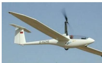
Le premier à un moteur fixe non retractable que l'on peut bien sûr éteindre en vol, l'autre un moteur sur pylone retractable ce qui permet d'avoir un vrai planeur ballasté avec 60 kgs en permanence.
