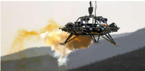
*L'atterrisseur du rover martien de la Chine testé dans des conditions simulant la gravité martienne*
